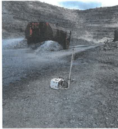
Зображенні №1 - рух полізрошувальної техніки під час поливу водою автодороги кар'єра №2-біс.
